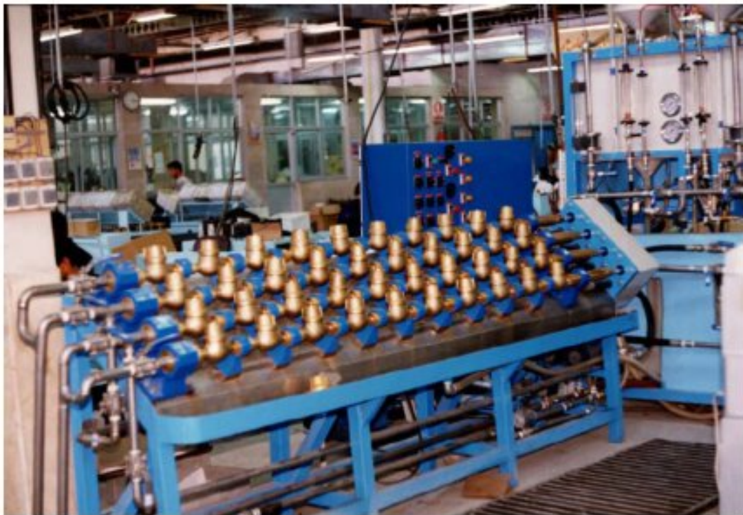
شکل ۴: دستگاه اتوماتیک تست گنطور
